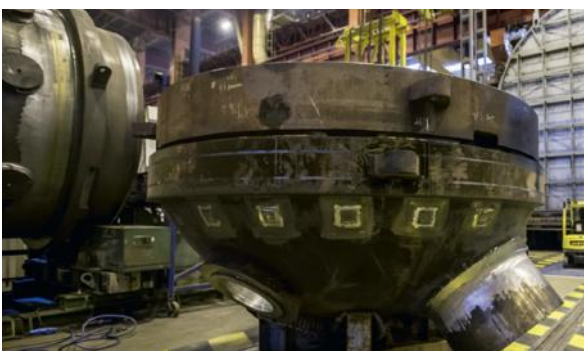
Fond de cuve du générateur de vapeur
