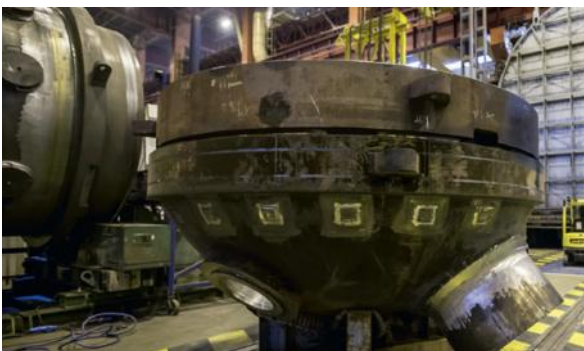
Fond de cuve du générateur de vapeur
