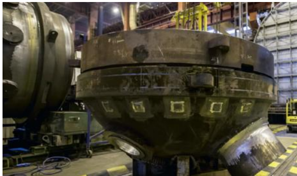
Fond de cuve du générateur de vapeur
